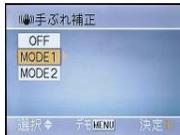
三脚使用時はOFFをオススメします。カメラが三脚と共に振動する揺れは、人間の手ぶれの揺れと違うため、手ぶれ補正機能の誤動作の原因になるようです。
